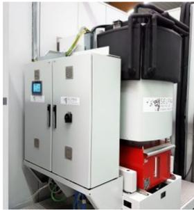
La machine de broyage de SELFRAG AG utilise des décharges à haute tension et des ondes de choc pour briser relativement rapidement des barres de silicium en petits morceaux qui sont tous d'une taille similaire. C'est par cette démonstration impressionnante que SELFRAG présente sa technologie de fragmentation révolutionnaire.
